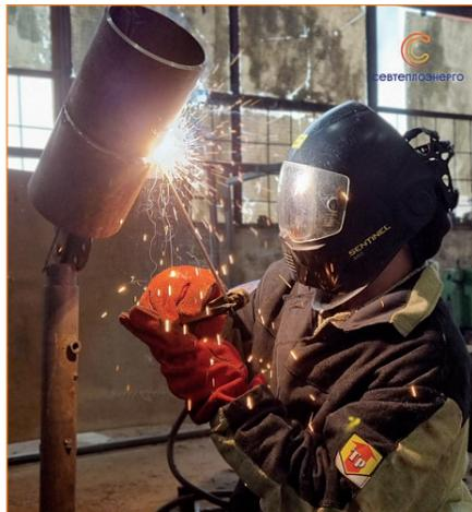
Традиционно сначала участники должны были сварить две трубы, установленные под углом 45 градусов друг к другу, за фиксированное время.
